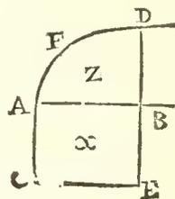
II. Si donc on prend une Equation quelconque pour déterminer la Relation de  $x$  & de  $z$  , on en tirera la Valeur de  $\dot{z}$  , & l'on aura ainsi deux Equations , dont l'une déterminera la Courbe & l'autre son Aire.
